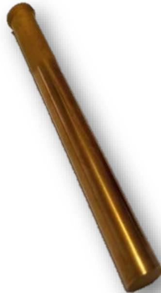
*Abbildung 2 TiC/TiN-CVD-beschichtetes Werkzeug*
